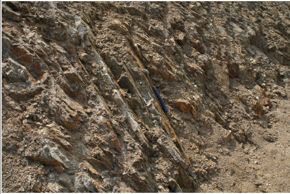
【그림 11】 조밀하게 발달한 불연속면
