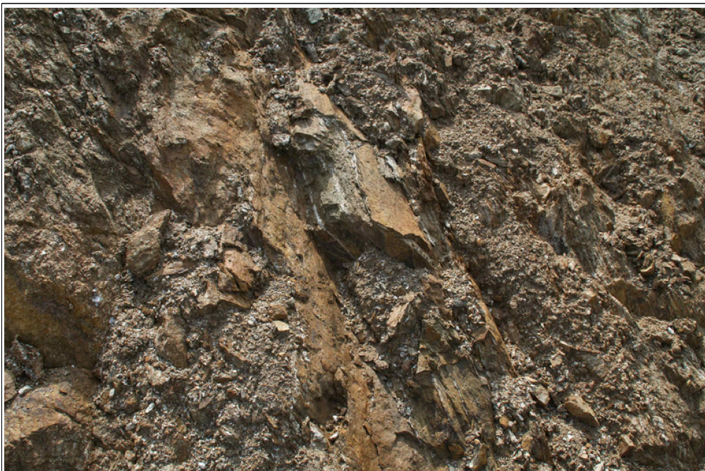
【그림 40】 C 영역 상세사진 (조밀하게 발달한 불연속면)
