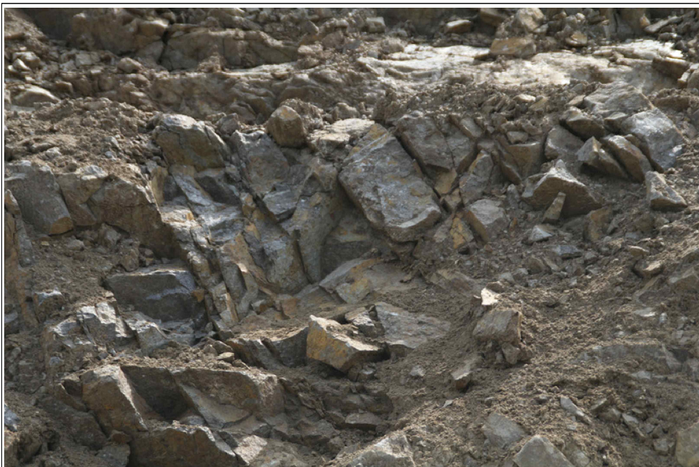
【그림 45】 D 영역 상세사진 (이완된 암편)
