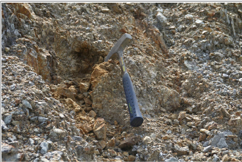
【그림 23】 A 영역 상세사진 (심한 풍화 상태)
