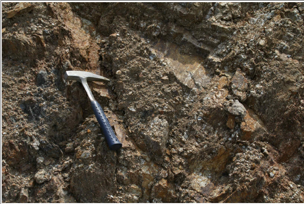
【그림 22】 A 영역 상세사진 (심한 풍화 상태)
