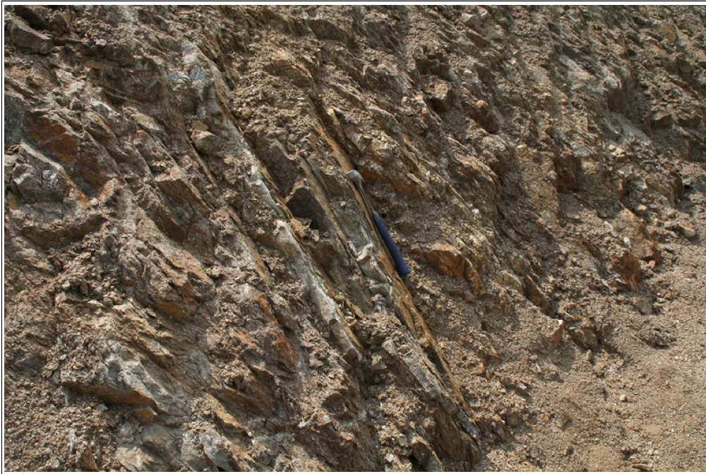
【그림 39】 C 영역 상세사진 (조밀하게 발달한 불연속면)
