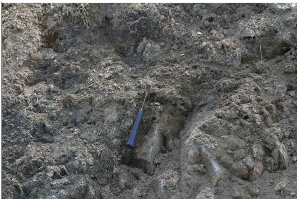
【그림 35】 B 영역 상세사진 (심한 풍화 상태)
